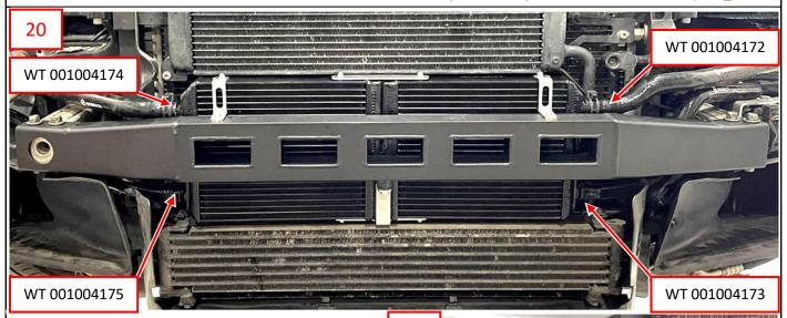
Verbinden Sie die WT Wasserschläuche mit den WT Wasserkühlern (20). Befüllen und Entlüften Sie anschließend das gesamte Motorwasser-Kühlsystem.
