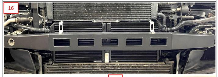
Montieren Sie die WT Wasserkühler und WT Quertraverse am Fahrzeug (16).
